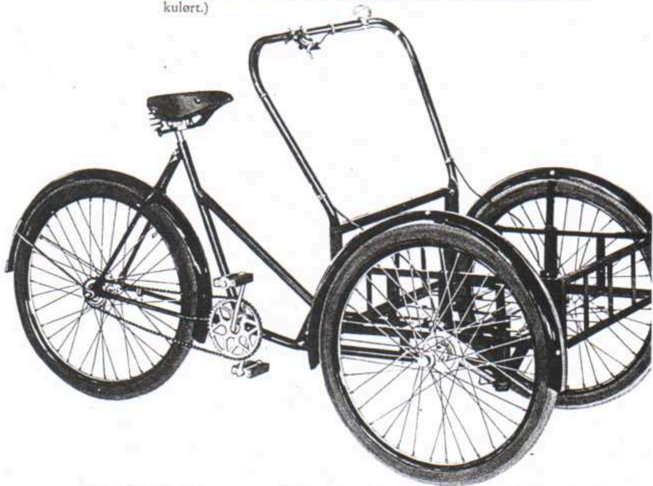
Nr. 122 Trehjuls transportsykkel med romslig varestativ (61 cm \times 61 cm). 26" transportdekk på alle hjul. Stålfelger, 2,5 mm eker. Bare i sortlakkert utførelse.
